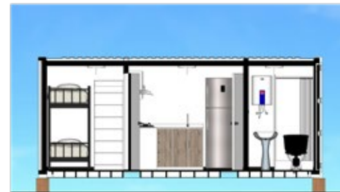
4 Vista Corte A-B ESC: 1/20
